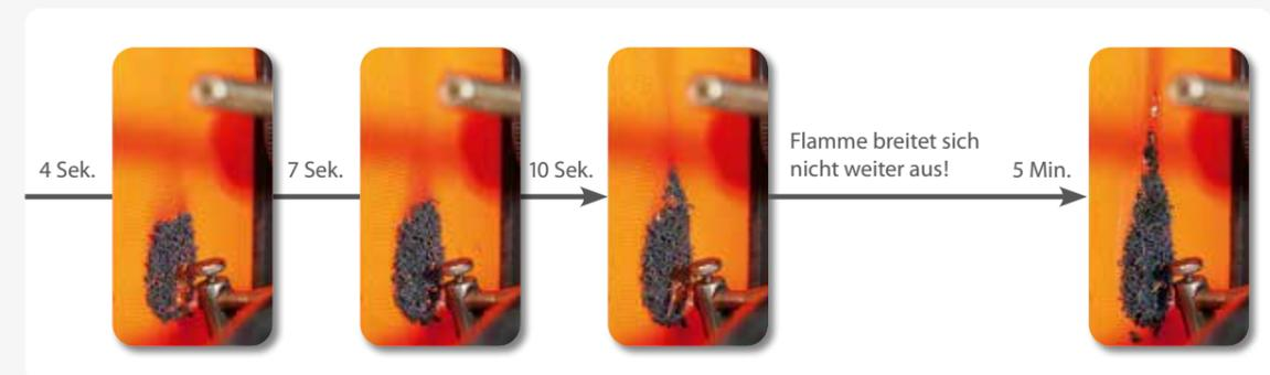
Dieser Test misst die begrenzte Ausbreitung von Flammen in vertikal ausgerichteten Geweben, wenn sie einer definierten Flamme ausgesetzt sind. Das pyroshell™-Flammschutzgewebe besteht den Test nach 10 Sekunden und die Flamme breitet sich sogar nach 5 Minuten nicht mehr weiter aus.
